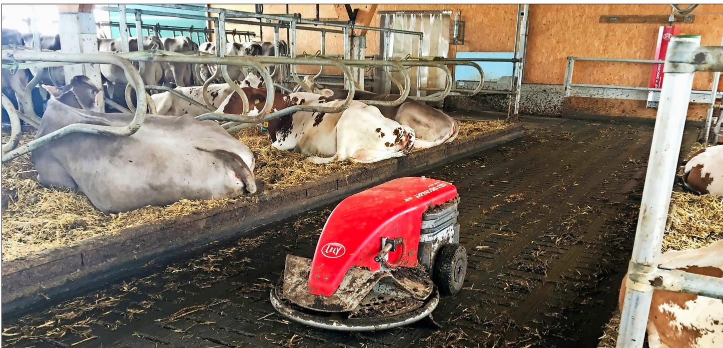
Bei perforierten Laufflächen ist eine Reinigung beispielsweise mit einem Entmisterroboter erforderlich. Der Durchtritt durch die Spalten allein reicht nicht aus. (Bild: Agroscope)
