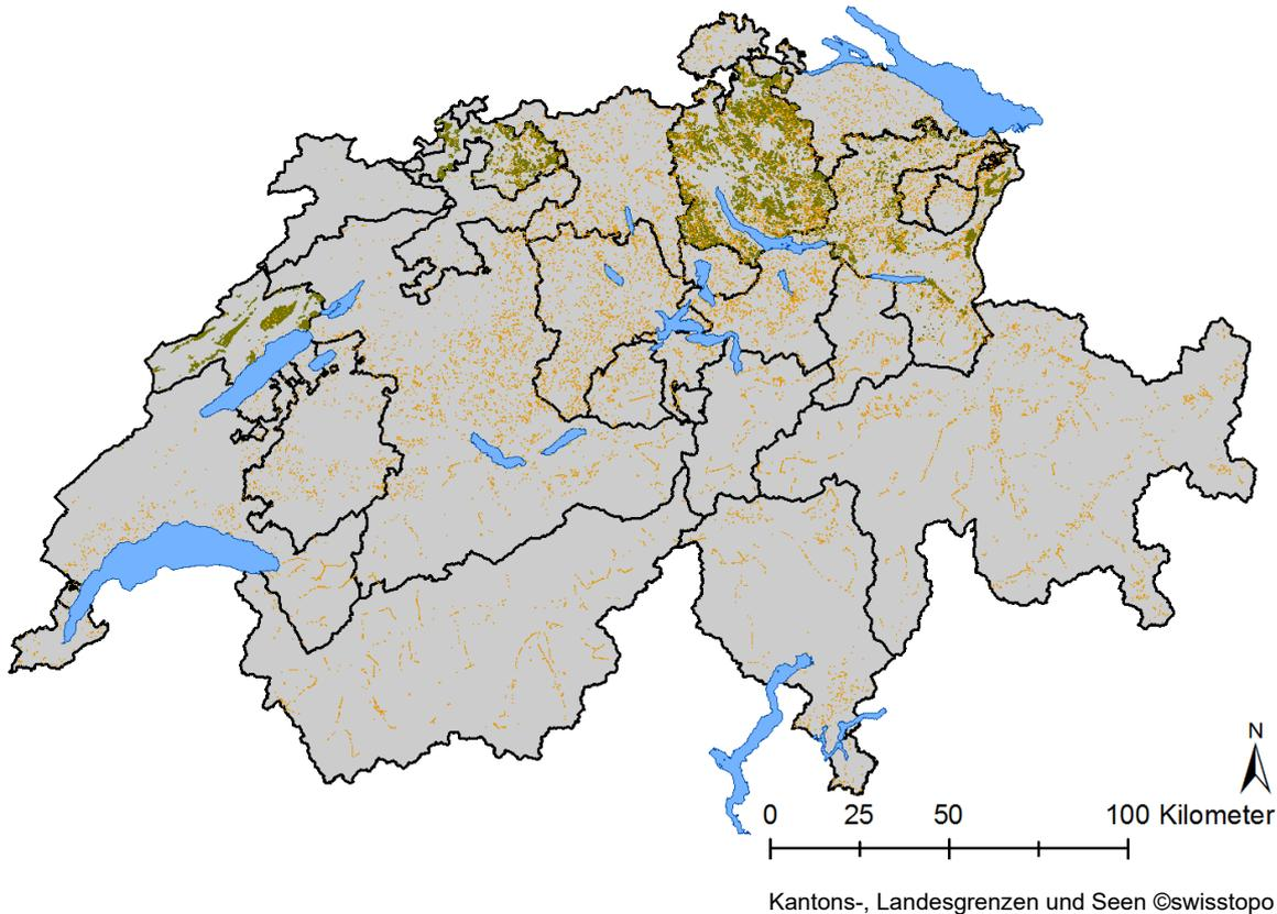
**Abbildung 9. Digitale Drainagepläne standen aus den Kantonen BL, NE, SG, ZH zur Verfügung (grüne Flächen 27'822 ha). Die orangenen Flächen zeigen bestimmte unterirdische Fließgewässer des TLM3d (10'204 ha). Ohne Überschneidungen (586 ha) wird insgesamt eine Fläche von 37'440 ha abgedeckt.**
