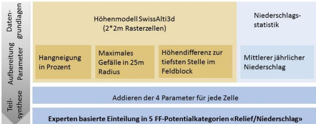
Abbildung 14. Ablaufschema für die Teilsynthese „Relief/Niederschlag“.
