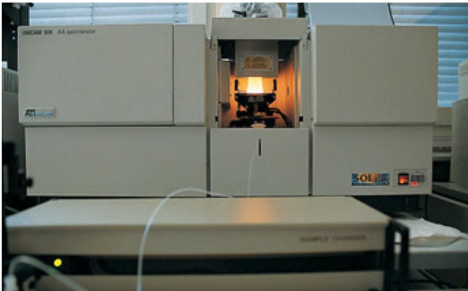
Mineralstoffe und Metalle lassen sich in Getränken mittels Atomabsorptions-Spektrometrie schnell und zuverlässig bestimmen.
