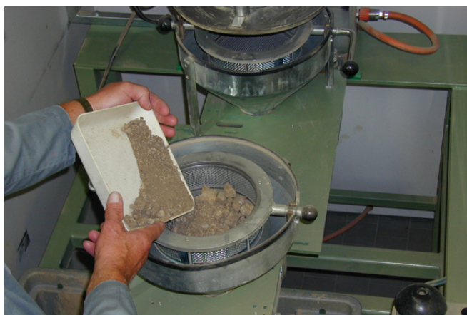
Figure 3. Préparation des échantillons de terre pour l'analyse en laboratoire: tamisage à 2 mm pour séparer la terre fine du squelette (photo: René Flisch, Agroscope).
