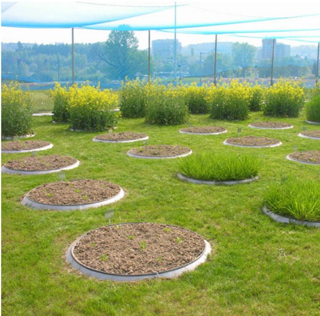
Abbildung 3 | Raps-, Kunstwiese- und Zuckerrübenverfahren in einer Lysimeteranlage von Agroscope am Standort Zürich-Reckenholz (Foto: Volker Prasuhn, Agroscope).
