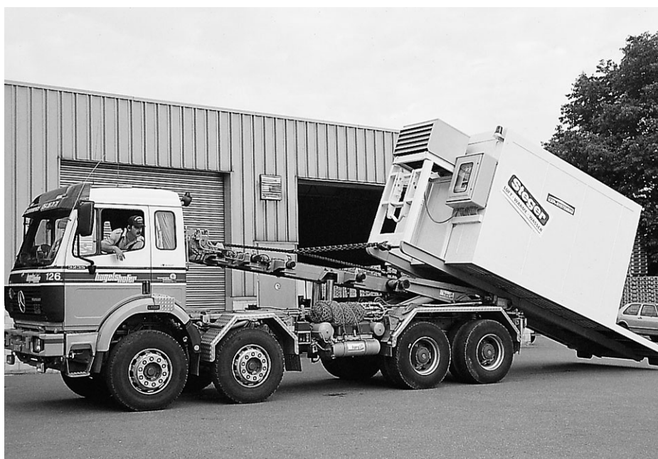
Abb. 4: Dank des transportablen Versuchskühlers konnten die Kühlversuche gleich an den Sammelstellen durchgeführt werden.
