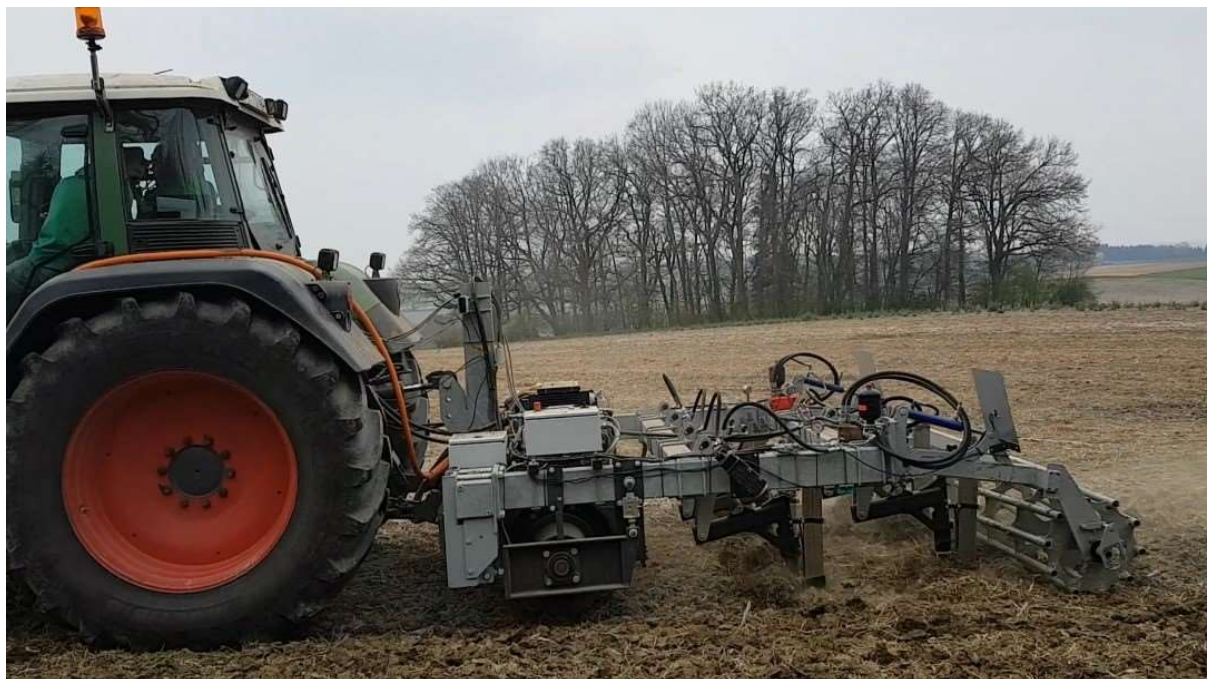
Abbildung 1: Der elektrifizierte Güllegrubber am Versuchsschlepper noch ohne Güllepumpe.
