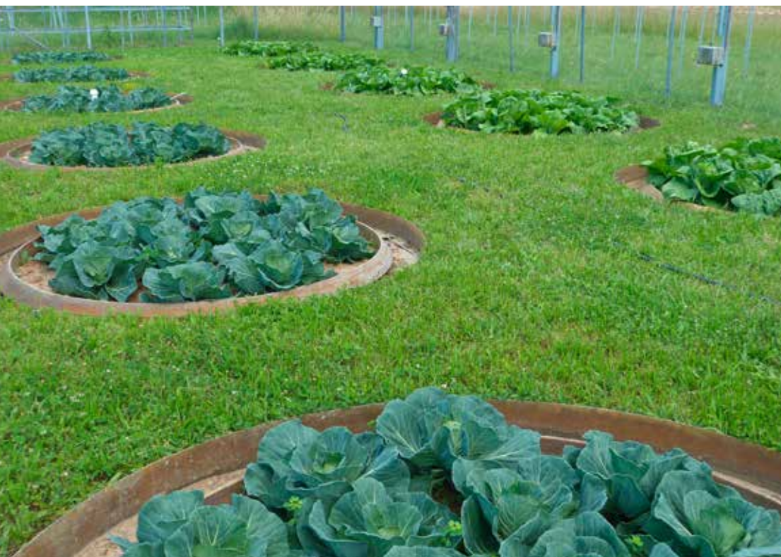
Messung der Nitratauswaschung unter Gemüsekulturen mit Lysimetern. (Foto: Ernst Spiess, Agroscope)
