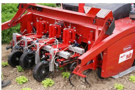
Photo 1: Dans le cadre du projet «Protection phytosanitaire économe en ressources et durable en cultures maraîchères grâce au robot de traitement piloté par caméra optique», on a combiné une bineuse Steketee et la technique Spot Spraying (photo: Agroscope).
