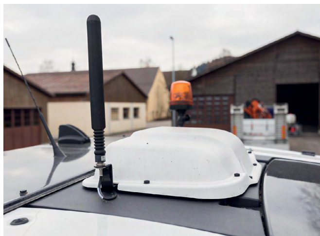
Abb. 4: Mit einem GNSS-Empfänger auf dem Traktordach und einem RTK-Korrektursignal (RTK = Real-Time-Kinematik) kann die Fahrzeugposition mit einer Genauigkeit von +/- 2 cm bestimmt werden. Die Positionssignale werden über ein Lenkventil automatisch in Lenkbewegungen umgesetzt.
