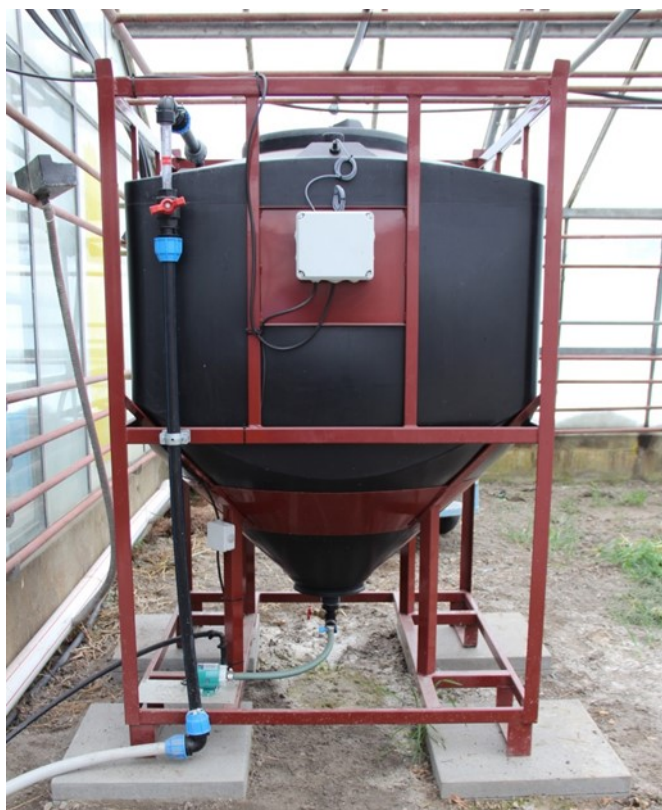
Figure 6. Filtre à sable pour filtration lente. (Photo : V. Günther)
