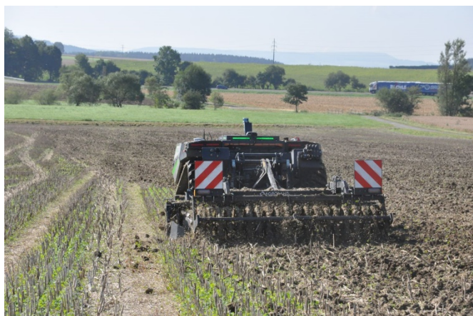
Fig. 4: Pour un déchaumage, cet AgBot a été programmé de manière à travailler dans la diagonale des lignes existantes. La qualité du travail de la herse à disques est ainsi améliorée et l'on évite de compacter davantage les passages existants. (photo: Agroscope).
