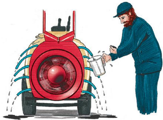
Berechnung: Durchfluss Einzeldüse l/min/Düse
