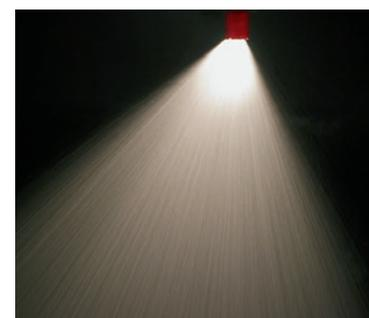
Durchfluss für Lechler IDKS Schrägstrahldüsen, geeignet für Elektromembranpumpen bei 1.5 bis 3 bar.
