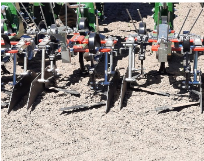
Figure 1: Les lames plates inclinées associées à des plaques de protection des cultures ne donnent pas de résultats satisfaisants lorsque les sols sont très boueux, car les lames soulèvent de très grandes «plaques» et déracinent aussi les jeunes plantes de la culture (photo: R. Total, Agroscope).
