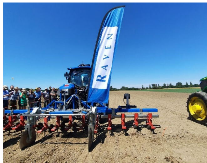
Figure 2: Système de guidage par caméra permettant le suivi précis des lignes de culture par les outils de binage de la firme Raven (photo: R. Total, Agroscope).
