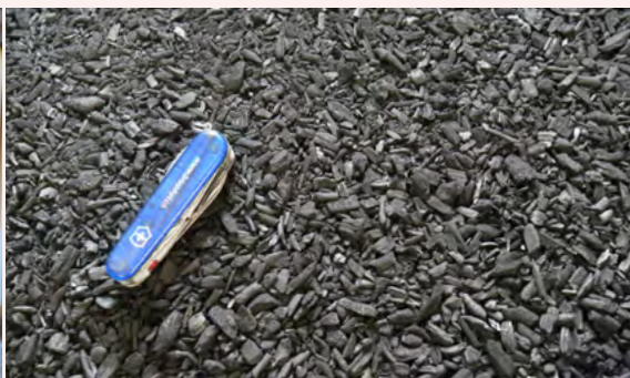
Foto 5.2: Biokohlen sollten eine regelmäßige Granulometrie und tiefe Schadstoffgehalte aufweisen; beides wird im Label «EBC» geprüft. Vom BLW werden nur Label-Biokohlen zugelassen.
