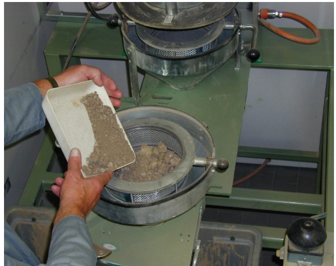
Figura 3. Preparazione dei campioni di suolo per le analisi di laboratorio: setaccio con maglie di 2 mm per separare lo scheletro dalla terra fine (fotografia: René Flisch, Agroscope).
