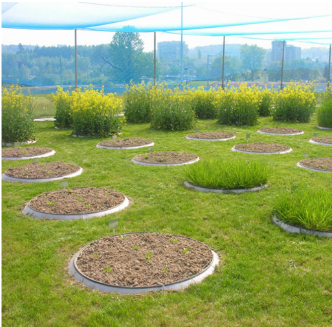
Figura 3. Parcelle sperimentali di colza, prato temporaneo e barbabietola da zucchero monitorate attraverso lisimetri, installati da Agroscope presso il sito di Zurigo-Reckenholz (fotografia: Volker Prasuhn, Agroscope).
