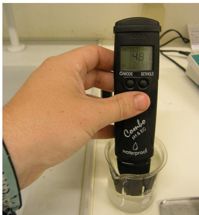
Figura 5. Misura del pH e della conducibilità elettrica (EC) di una soluzione nutritiva (fotografia: Agroscope).
