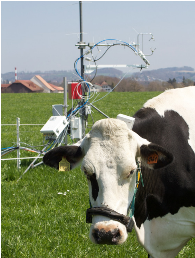
Figura 2. Misura della quantità di \text{N}_2\text{O} prodotto in un pascolo sperimentale con la tecnica detta «Eddy covariance» (correlazione turbolenta) (fotografia: Raphael Felber, Agroscope).
