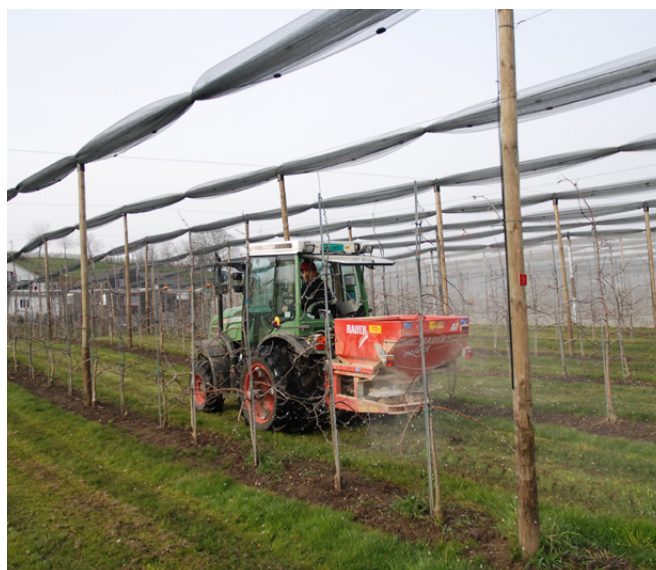
Figura 11. Spandiconcime centrifugo in azione durante una concimazione di superficie (fotografia: Thomas Kuster, Agroscope).
