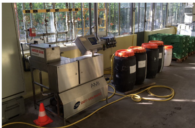
Figura 4. Installazione automatizzata per miscelare e gestire la fertirrigazione delle colture orticole in serra (fotografia: Agroscope).
