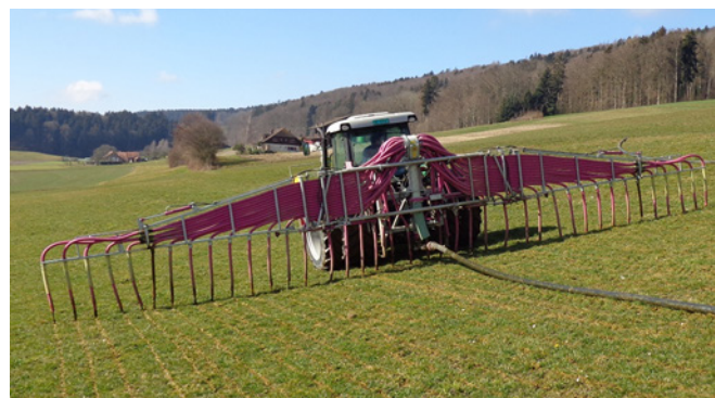
Figura 1. Le tecniche che distribuiscono liquami e digestati liquidi depositandoli sulla superficie del suolo per caduta (qui una barra equipaggiata con tubi flessibili a strascico) consentono di ridurre notevolmente la volatilizzazione dell' \text{NH}_3 rispetto ai metodi che li disperdono nell'aria (deflettore a piattello, distributore oscillante, ecc.) (fotografia: Harald Menzi, Agroscope).
