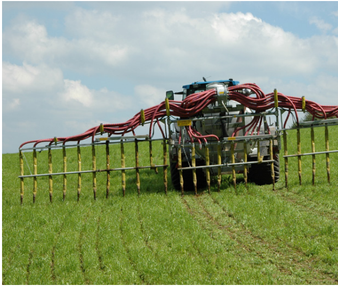
Figura 1. Distribuzione di liquame in rivoli paralleli su una superficie prativa, utilizzando una barra equipaggiata con tubi flessibili a strascico (fotografia: Agroscope).
