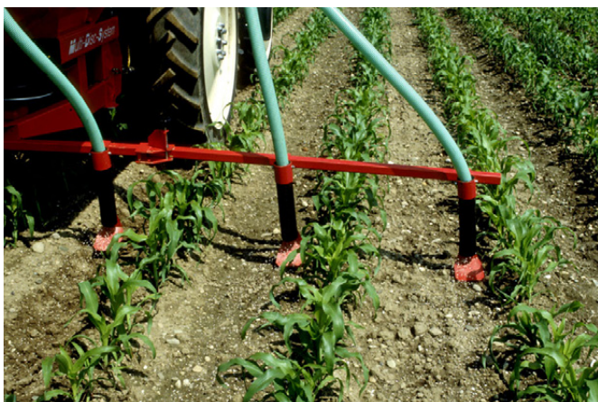
Figura 3. Localizzazione superficiale di un concime minerale lungo le file del mais, utilizzando un'apposita barra di distribuzione (fotografia: Agroscope).
