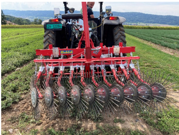
Schmaler Rollstriegel (1,50 m) zur Bearbeitung von Kulturen in Beeten
