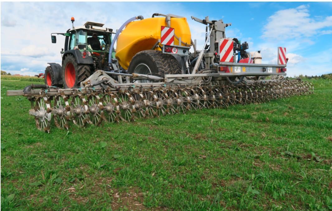
Bei der CULTAN-Düngung wird Stickstoff als konzentrierte Ammoniumlösung in den Boden injiziert. (Foto: Martin Häberli)
