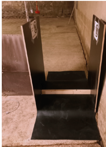
Abb. 2: Antennenfelder vor dem Einsatz im Stall. Die Antennen selbst sind in einen Sperrholzrahmen eingefügt und werden durch eine schwarze Gummimatte geschützt. (© Klinik für Geflügel)
