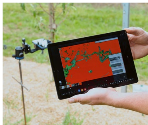
Abb. 3: Der Bedeckungsgrad mit Unkräutern wurde mit einem definierten Fotorahmen erfasst (l.) und anschliessend mit der Bildverarbeitungssoftware Fiji ausgewertet (r.). (© LWG)
