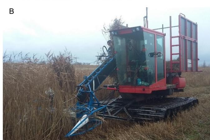
Abbildung 3: Ernte: A) Seggenkompaktierung mit angepasster Grünlandtechnik zur energetischen Verwertung (09/2019), Foto: F. Birr; B) Schilfmahd mit raupenbasierter Technik (12/2018), Foto: F. Birr.
