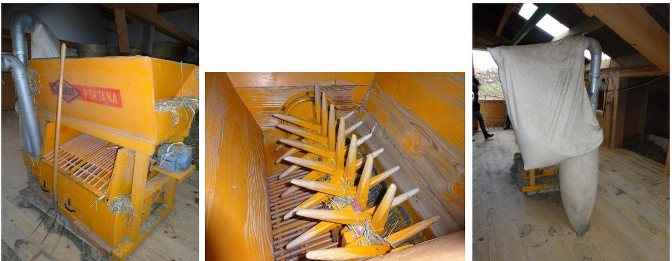
Beispiel einer Heurüstmaschine. Das Heu wird in den Trog eingefüllt und durch ein Schüttelwerk gelockert. Staub und Erde fällt nach unten, und die wertvollen Pflanzenteile und Samen werden in den weissen Sack abgesaugt. | © Agroscope, SNG, C. Wyss
