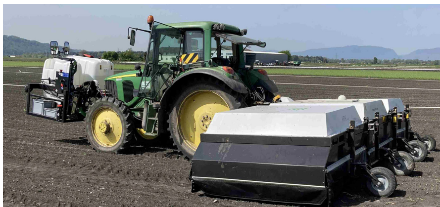
Photo 1: Lutte contre les adventices au moyen du pulvérisateur de précision ARA, piloté par I.A., de la firme ecorobotix (photo: Michael Gugger, Station d'essais Cultures maraîchères, Ins/Anet, Agroscope).
