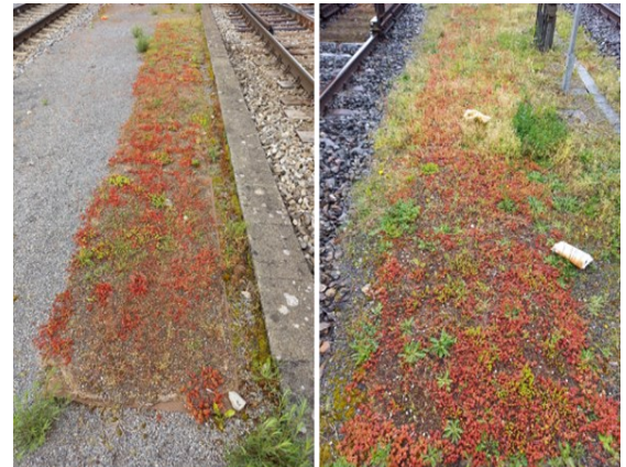
Abbildung 9: Zustand der Matten in den Zwischengleisbereichen auf Mergel in Cornaux (links) und Cousset (rechts) im Mai 2023
