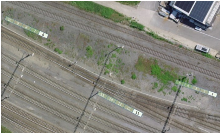
Abbildung 12: Cornaux Anordnung der Sedum-Matten Schotter: Matten 1 - 10; Die Matten 6 - 10 liegen auf einer Fläche mit mittlerem Bewuchs von Spon-tanvegetation Kies: Matten 11 - 15. Ohne Vlies grüne Flächen, Mit Vlies weiss schraffierte Flächen (© swisstopo: www.geo.admin.ch)
