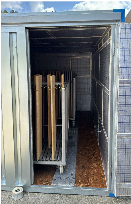
Abbildung 11: Beispiel einer mit einem Gerät zur Unkrautbekämpfung durch Hitze funktionierenden Dampfzelle
