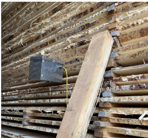
Abbildung 8: Feuchtigkeitskontrolle bei den Brettern
