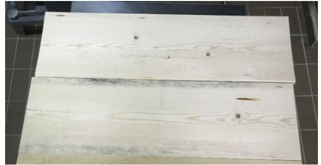
Abbildung 14: Neue Bretter mit 37 % Feuchtigkeit, Befall mit schwarzem Schimmel
