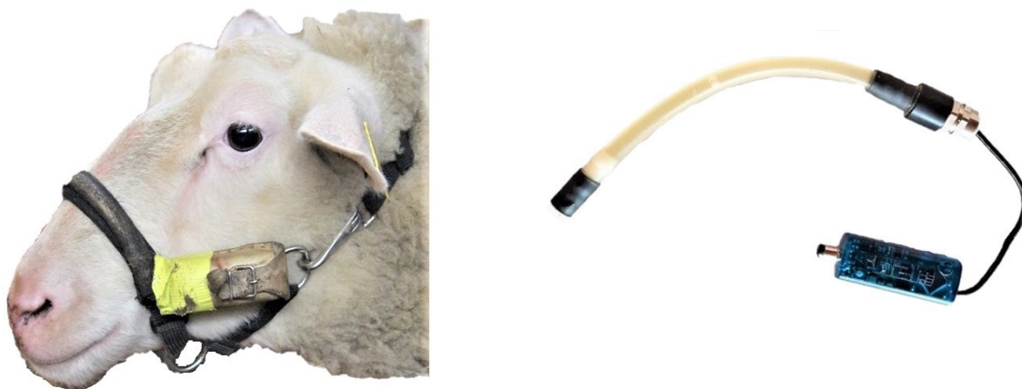
Figura 3 a, b: Ovini lattiferi con cavezza per la registrazione automatica del comportamento alimentare. Nell'archetto nasale è presente un tubo pieno d'olio, le cui variazioni di pressione vengono rilevate dal sensore al movimento della bocca.
