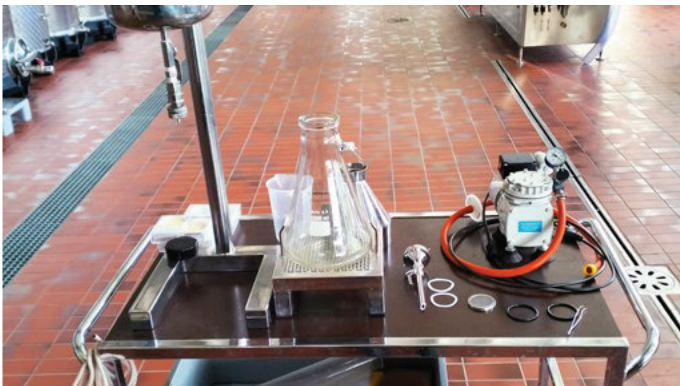
Équipement nécessaire pour réaliser les tests de filtrabilité IC et V_{max} . Photo : Haute école de Changins.
