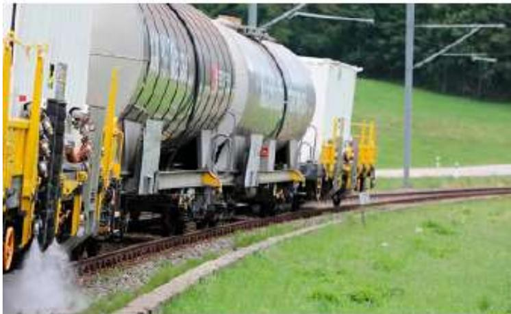
Abb. 1 | Prototyp des von der SBB entwickelten Heisswasser-Spritzzuges. (Foto: SBB)
