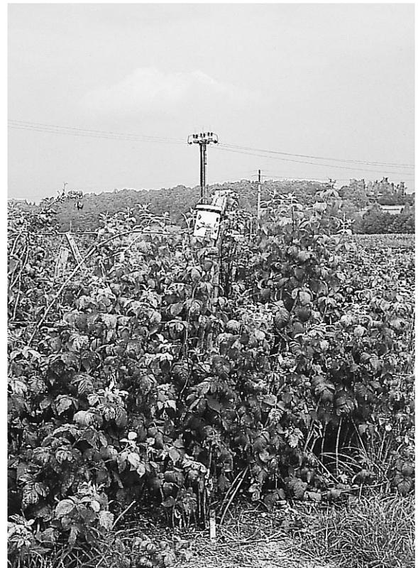
Abb. 3: Eine lokale Wetterstation (Datalogger Hotdog, weisses Kästchen) misst sowohl die Luft- als auch die Bodentemperatur unter offenem Boden ausserhalb der Himbeeranlage.
