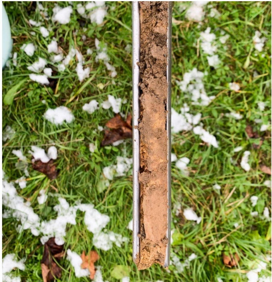
Abb. 1: Mit dem Bohrstock wurden die Bodenproben entnommen. (@ Agroscope)
