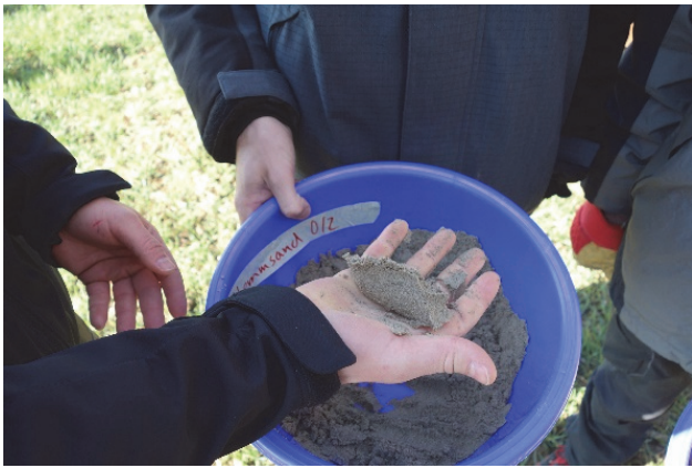
Abb. 5: Mithilfe des praxistauglichen Sand-Handtests kann die Eignung von Sand als Haufenmaterial überprüft werden (Foto: LZ Liebegg).
