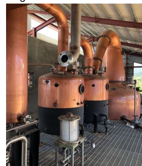
Fig. 3: Alambic traditionnel à repasse dans la distillerie de rhum (photo: Pascal Kälin)
