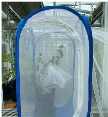
Double système de protection lors de l'expérimentation dans la serre de biosécurité de niveau 3 du WSL. JÚLIA LÓPEZ MERCADAL
