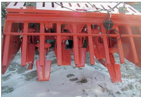
Abb. 2: Spatenmaschine.
