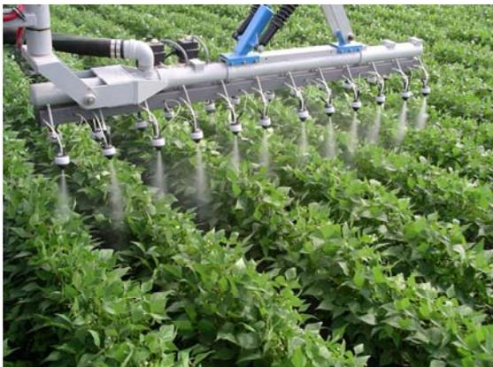
**Abbildung 2:** Linke Balkenhälfte des 8m breiten Elektrostatiksprayers mit Luftunterstützung beim Besprühen des Buschbohnenbestandes mit 107 l/ha und 4.2 km/h.
