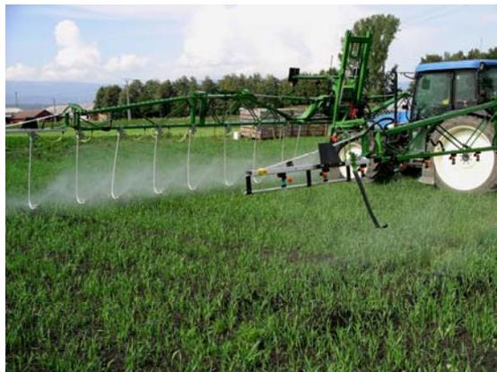
**Abbildung 3:** Amazone Feldbalken 15m mit Twin-Spray-Caps und Kompaktinjektordüsen hinten sowie 15m Amazone Feldbalken mit Unterblattspritzvorrichtungen (droplegs) vorne. Kurzes Testsprühen mit Wasser vor Zugabe der Markiersubstanz und der Produkte.
