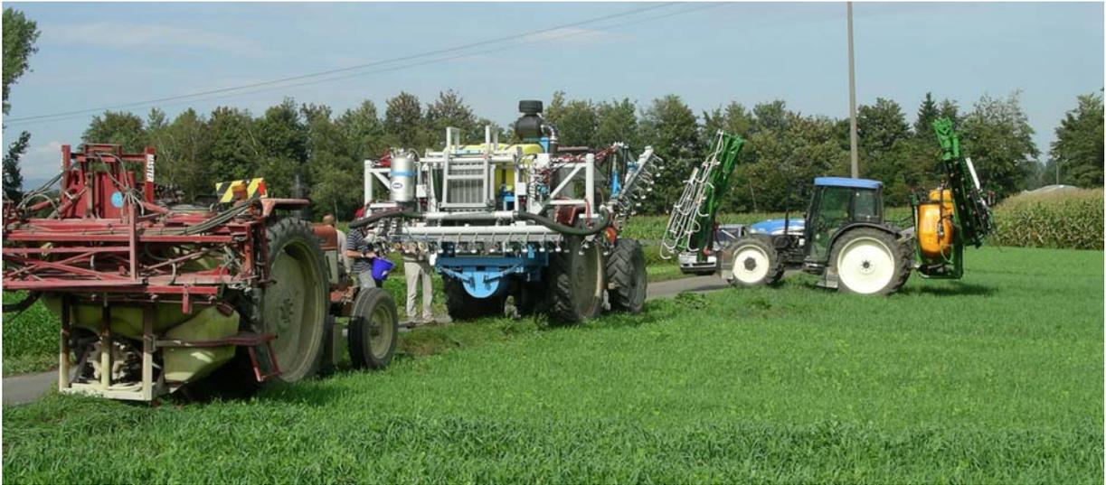
Abbildung 1: Geräte für den Vergleichstest, von links nach rechts: Standardfeldbalken „Master“, Elektrostatik – Sprayer ESS, Amazonefeldbalken mit Twin-Spray-Caps hinten und Amazonefeldbalken mit Unterblattspritzvorrichtung (droplegs) vorne.
