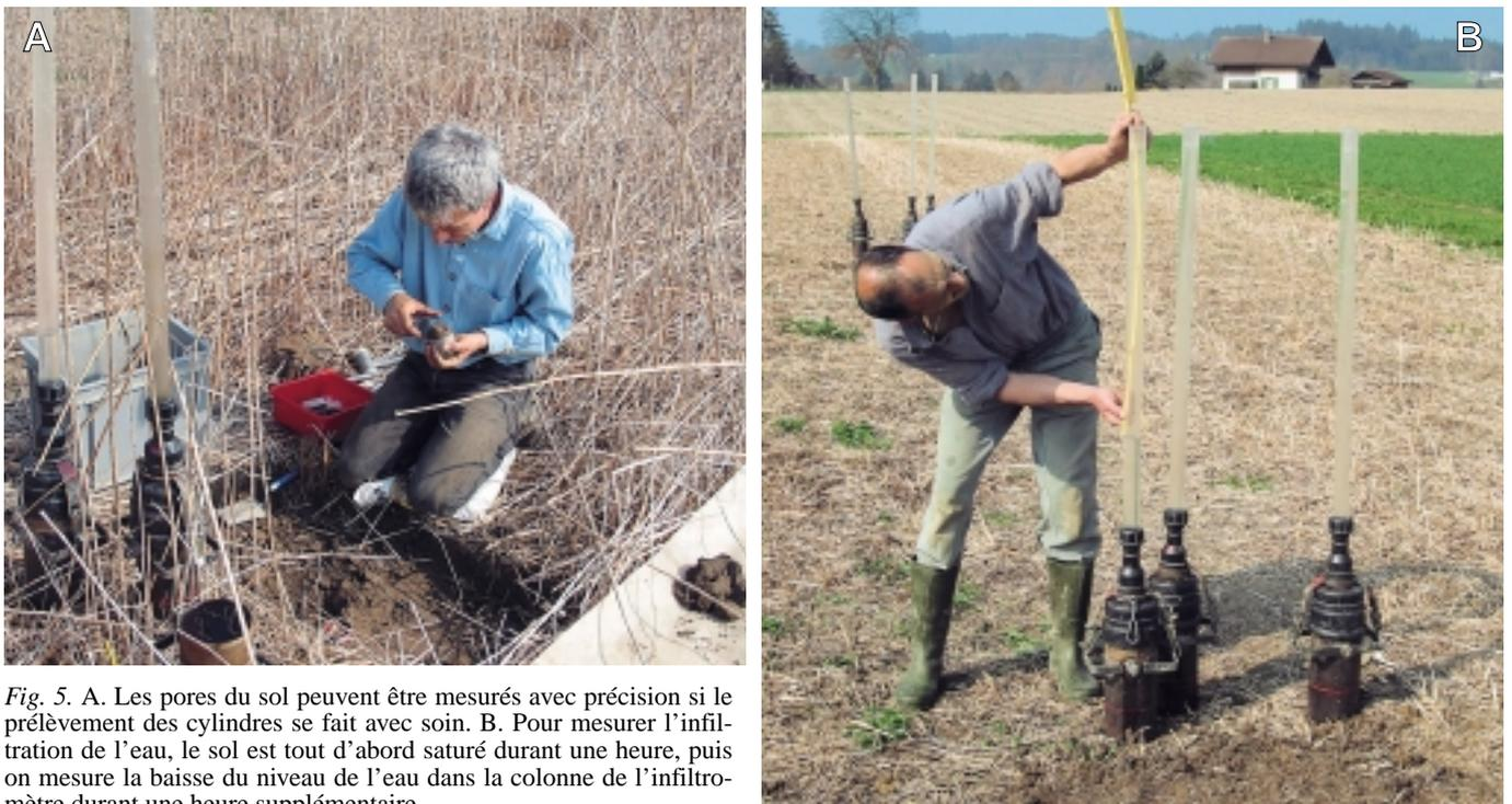
Fig. 5. A. Les pores du sol peuvent être mesurés avec précision si le prélèvement des cylindres se fait avec soin. B. Pour mesurer l'infiltration de l'eau, le sol est tout d'abord saturé durant une heure, puis on mesure la baisse du niveau de l'eau dans la colonne de l'infiltromètre durant une heure supplémentaire.
