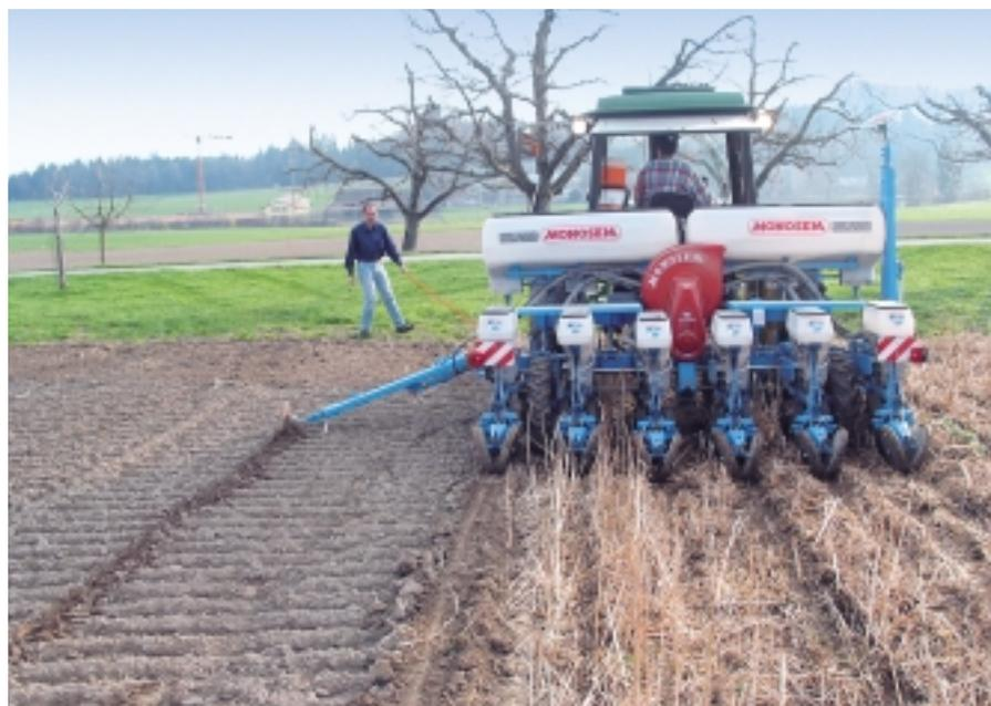
**Fig. 3.** Le même semoir de précision pour semis direct est utilisé dans les deux systèmes de culture - semis direct ou labour - afin d'obtenir un peuplement de densité comparable.
