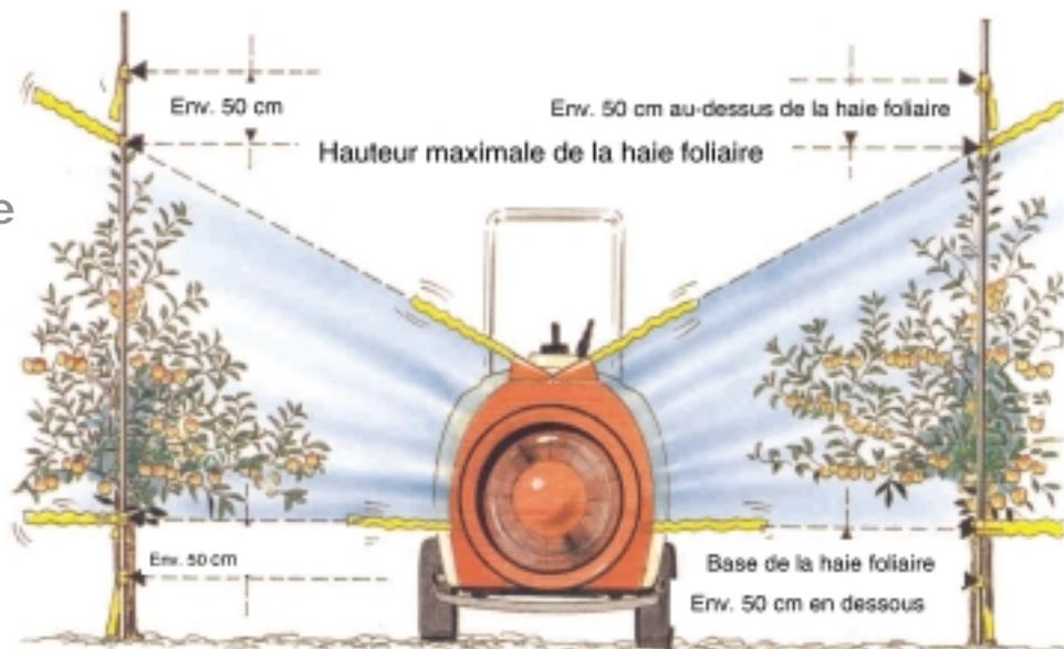
Les bandes placées environ 50 cm au-dessus et au-dessous de la haie foliaire ne doivent pas être sous l'influence du courant d'air produit par la turbine.
