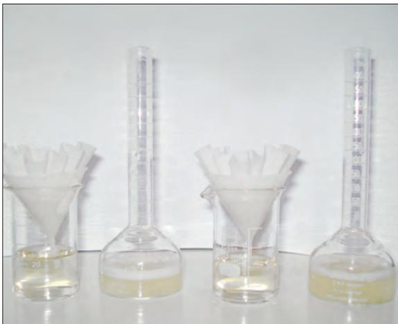
Abb. 1a: Bentotest: Filtration von Proben.
