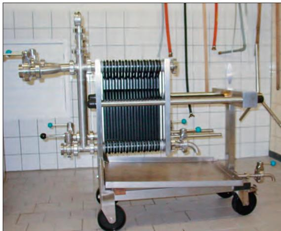
Abb. 2a: Schichtenfilter.
