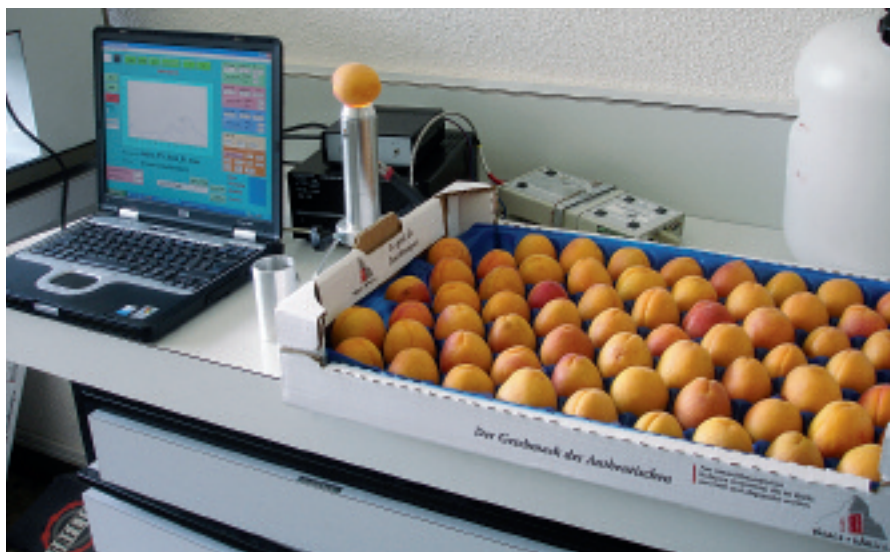
Spectromètre proche infrarouge portable utilisé pour l'analyse de la qualité interne des fruits.
