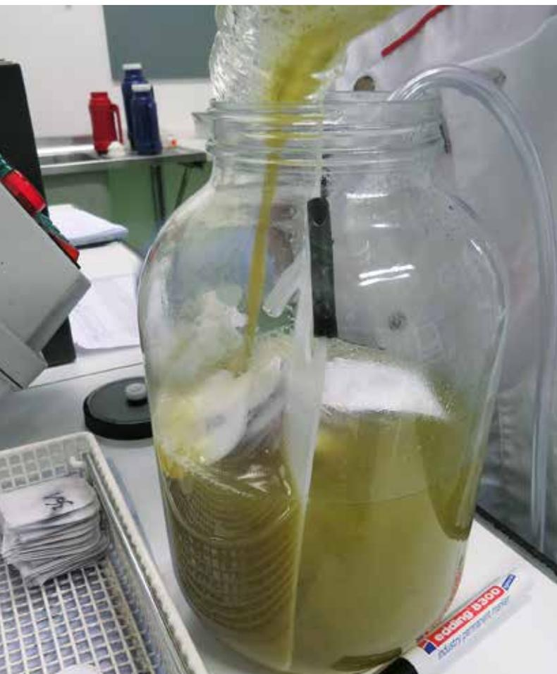
Das Inkubatorglas, das die Säckchen und Puffersubstanzen enthält, wird unter CO<sub>2</sub>-Atmosphäre mit Pansensaft befüllt.
