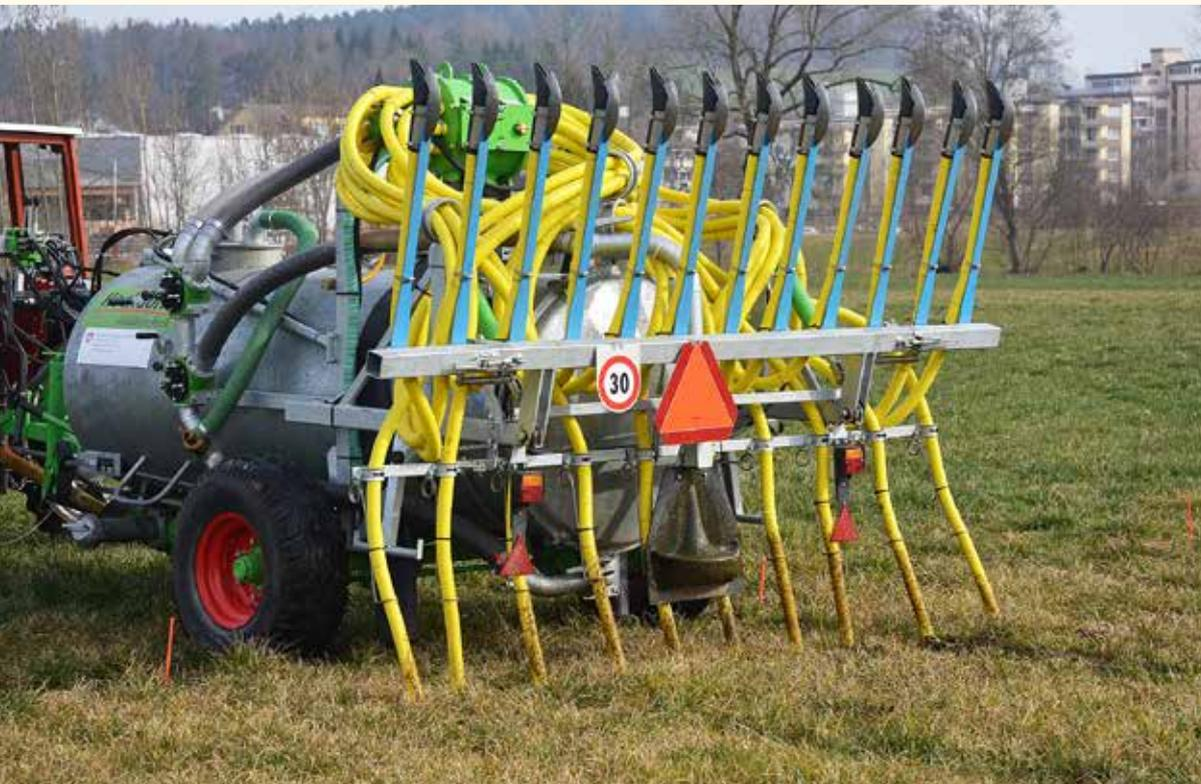
Der Versuch zum Einfluss von zwölf verschiedenen Gülleapplikationsverfahren auf den Wiesenertrag (Standort Tänikon) wurde mit einem mit Breit-, Schleppschlauch- und Schleppschuhverteiler ausgerüsteten Versuchsgüllefass durchgeführt. (Foto: Annett Latsch, Agroscope)
