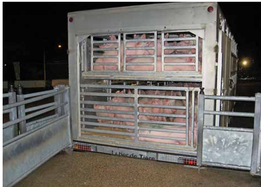
Un exemple de grille arrière pour un véhicule de transport à deux étages destiné aux porcs.
