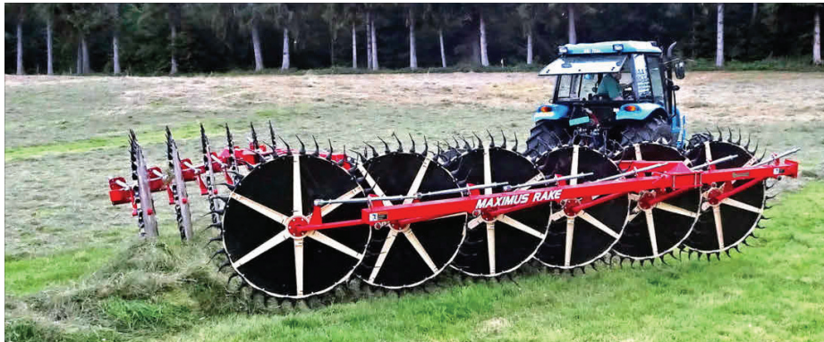
Der Sternradrechen ist bodengetrieben und benötigt eine zügige Arbeitsgeschwindigkeit. (Bilder: Ueli Wyss, Agroscope)
