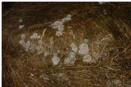
Film étirable avec une mauvaise tenue aux ultraviolets
