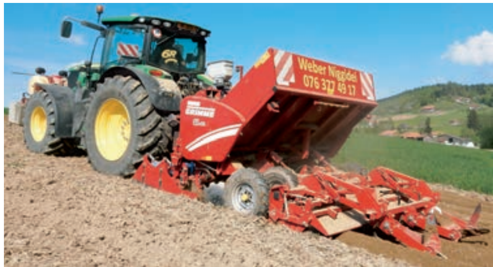
Der Dyker im Einsatz an einer Kartoffellegemaschine Grimme GL 420 (All-in-One).
