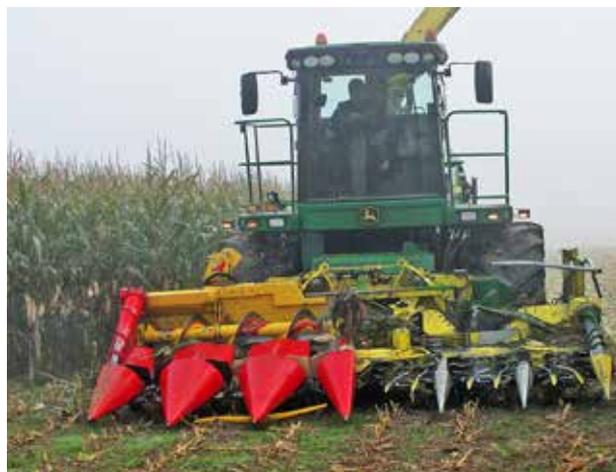
**Abb. 1** | Häcksler zur Herstellung von Powermais mit dem drei Reihen ganze Pflanzen und drei Reihen nur die Kolben geerntet wurden. (Foto: Ueli Wyss, Agroscope)
