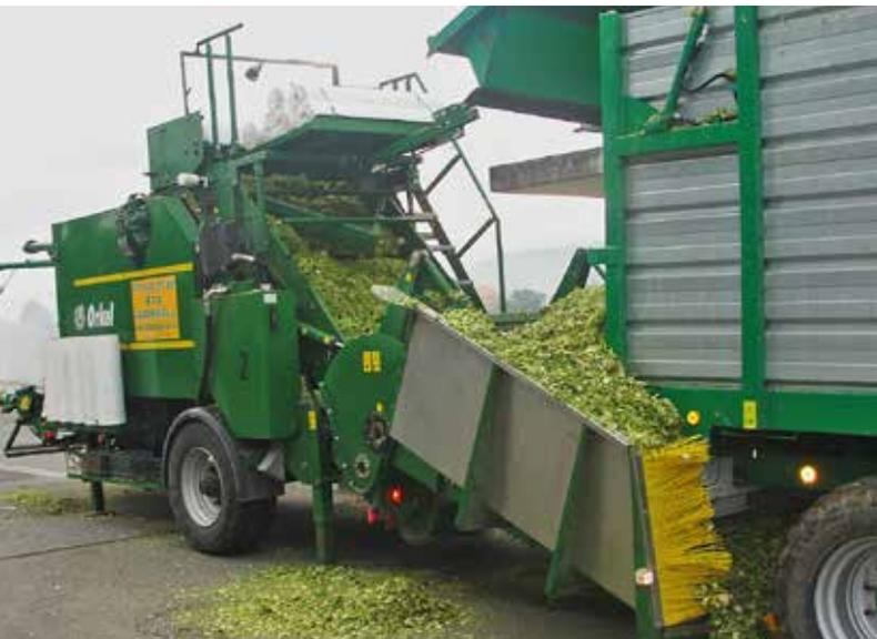
Die verschiedenen Maisballen wurden mit einer stationären Ballenpresse gepresst. (Foto: Ueli Wyss, Agroscope)
