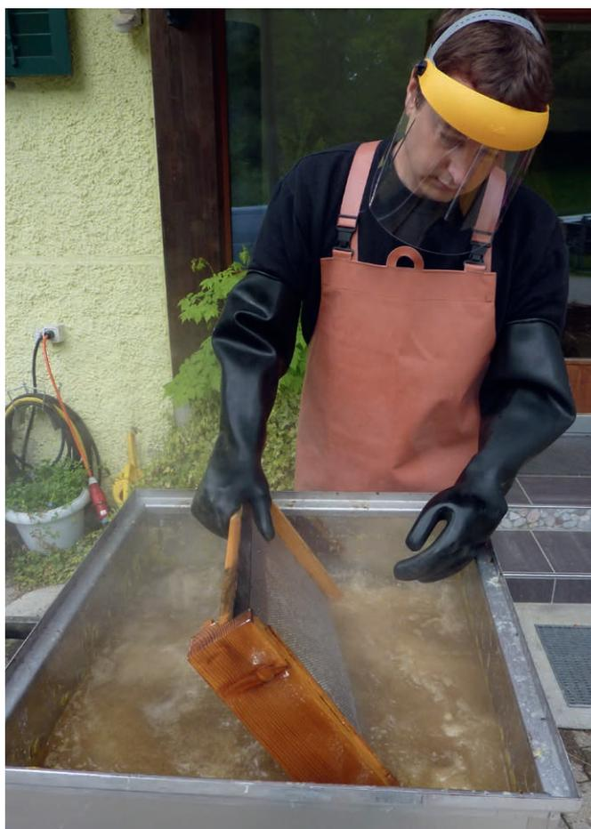
Figura 7: La soda caustica è più pericolosa del carbonato di sodio. Nell'impiegare entrambe le sostanze vanno comunque indossati indumenti di protezione (foto T. Amsler).
