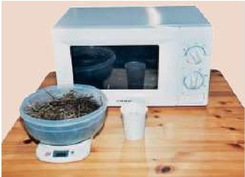
Das Verfahren eignet sich zum schnellen Abschätzen des TS-Gehaltes. Die Trocknungsdauer hängt vom Feuchtegehalt und des Probenmaterials (harte Stängel und Maiskörner) ab. Das Trocknen dauert zwischen 15 und 45 Minuten.
