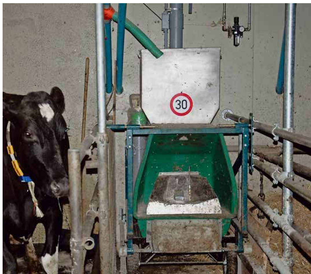
Développé aux Etats-Unis, le système GreenFeed permet de mesurer les émissions de gaz respiratoires des ruminants, sans entrave ni contrainte pour l'animal.
